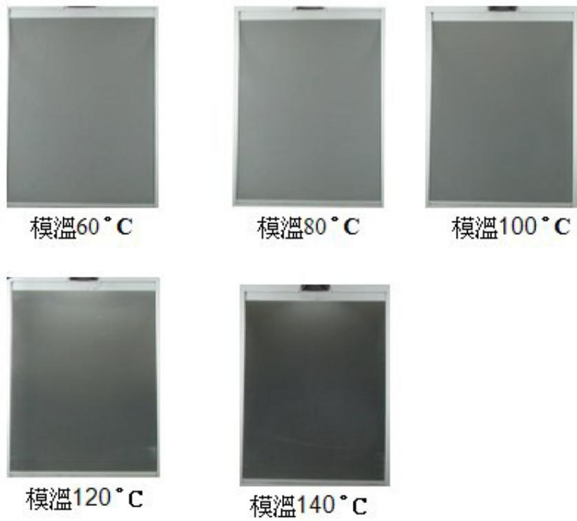
圖 5-39 射出壓縮成型應力光彈
