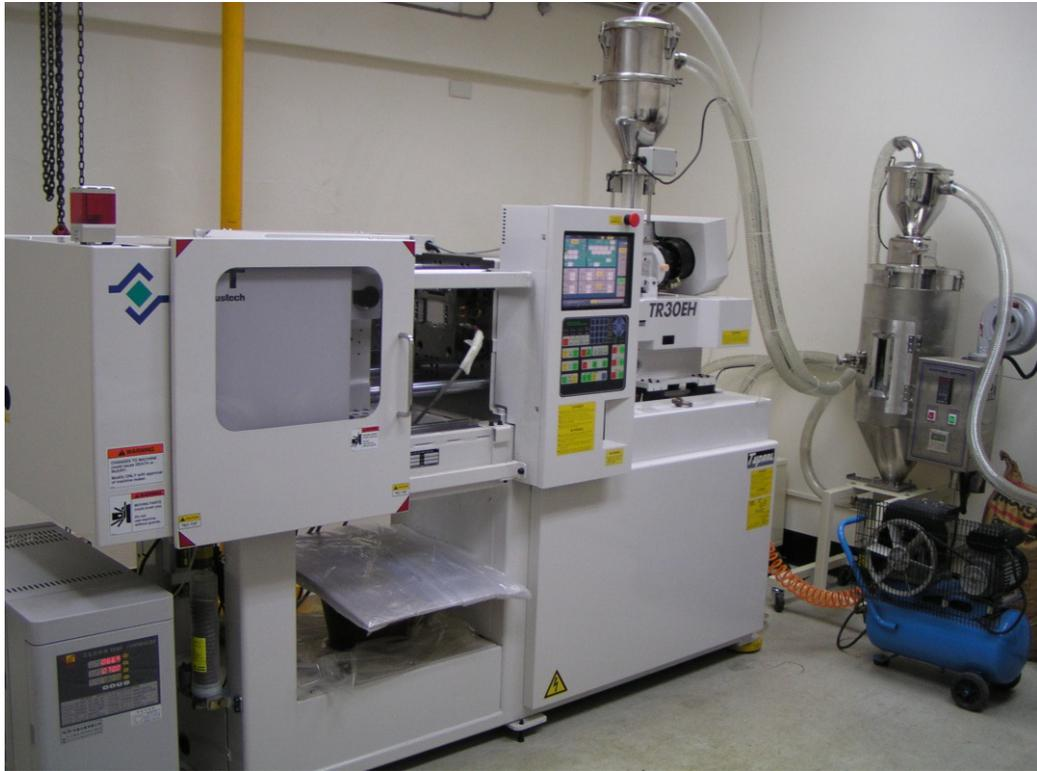
圖 4-2 Sodick-TR30EH 油電複合式 V 型機構射出成型機
