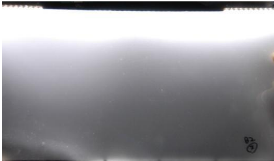
(c) 螺桿多段射出速度 3(最高速為 800mm/sec)時導光板應力痕分佈
